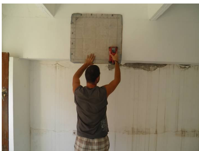
P9120083 носеща армировка в сглобяема греда
