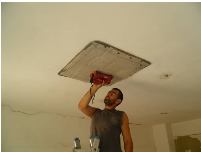
P9120093 носеца армировка в подов панел
