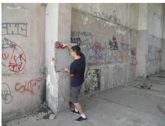
P9120067 носеца армировка в сглобяема колона
