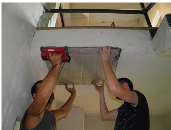
P9120098 носеца армировка в подов панел
